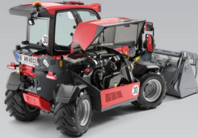
Si vous avez besoin de plus de puissance, des moteurs plus puissants sont proposés. Pour ceux-ci, la phase V de la norme d'émissions est respectée grâce à l'installation d'un filtre à particules diesel (DPF) combiné à un catalyseur d'oxydation diesel (DOC). Une solution d'urée (DEF) n'est pas nécessaire avec cette technologie.
