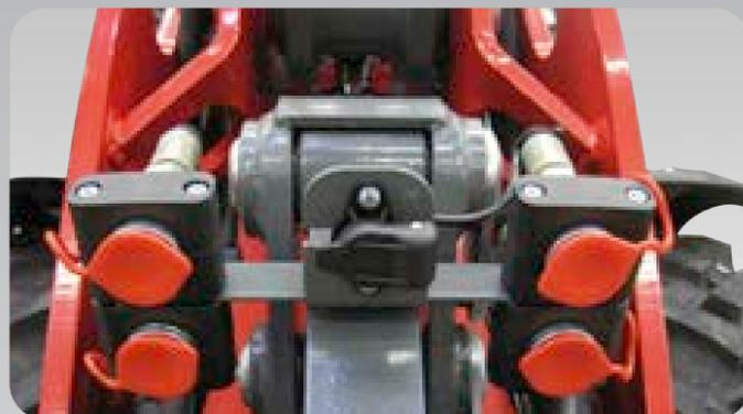
**4<sup>e</sup> circuit hydraulique séparé à commande individuelle :**
